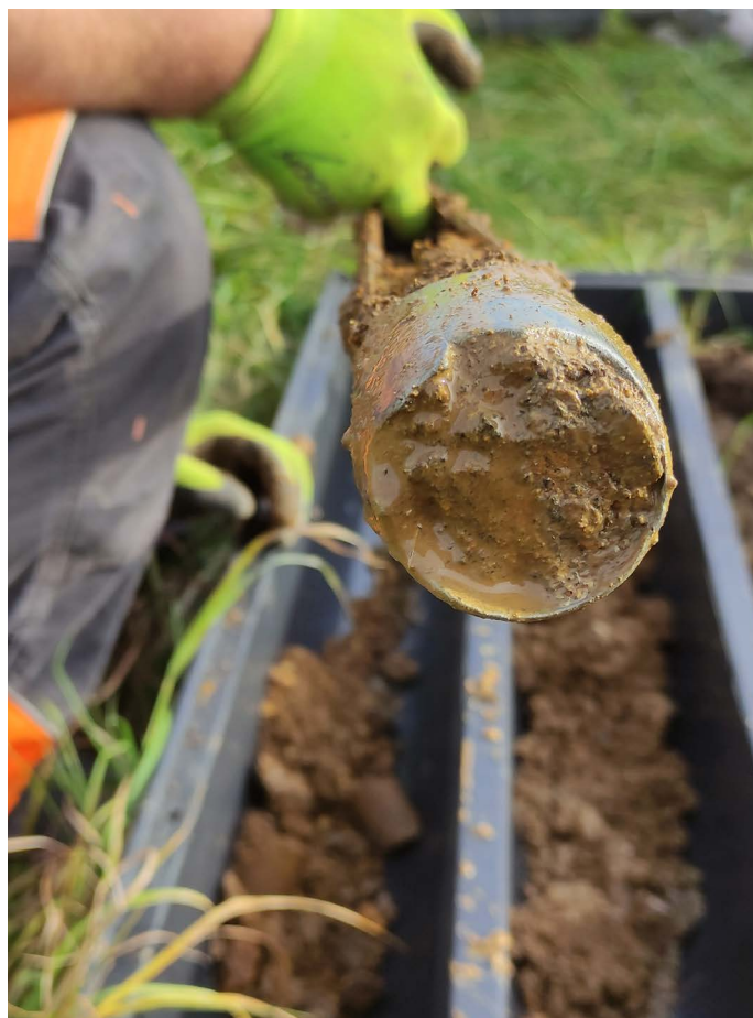
Detail průsaku podzemní vody v sondě S3
